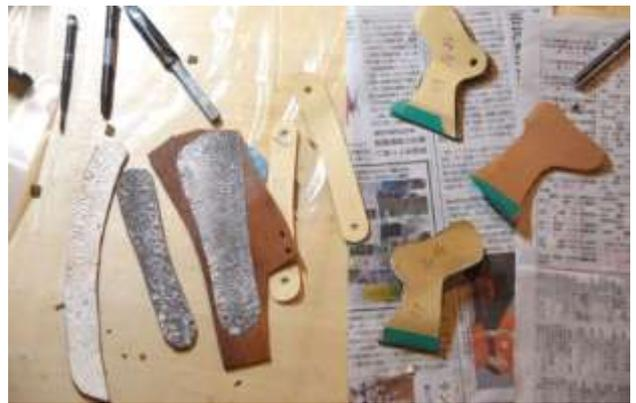
サンダル作りワークショップは各自なめした皮に着色を施した状態で持参、型紙に合わせて切り、はり合わせるために叩く。補強のための皮に縫い合わせて、革のパーツを作成していく。
