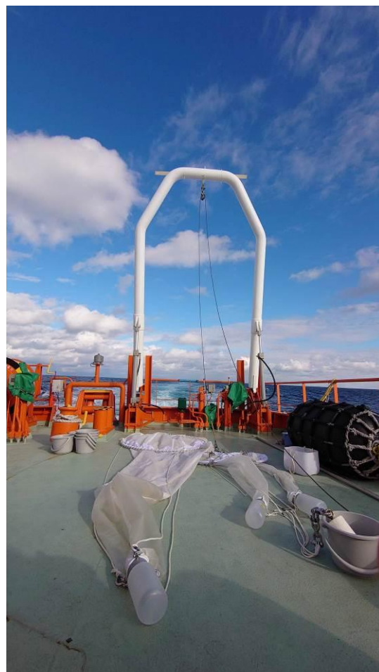
調査設備 A フレームとプランクトンネット
