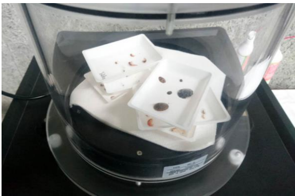
真空凍結乾燥中のフランクトン試料（フリーズドライ）
