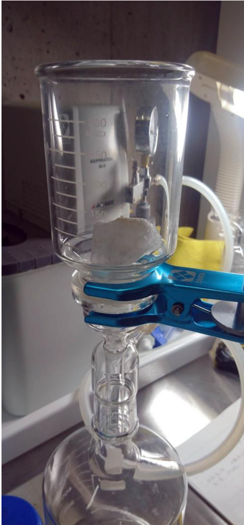
アイスアレルギーを含む流水を溶かして、吸引濾過している様子
